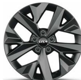
18" hliníkové disky kol s pneumatikami 235/55 - GT-Line HEV
